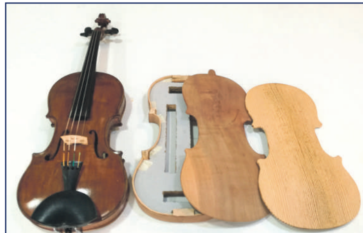
Violín acabado y dos en proceso de construcción.
